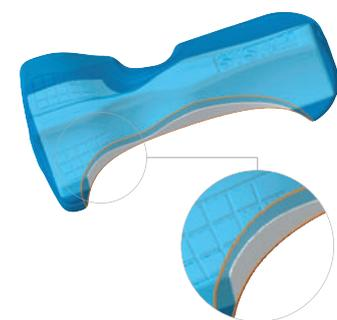
**STABILISIERUNGSEINSATZ (KALTSCHAUMSTOFF 40 KG/M<sup>3</sup>)**
